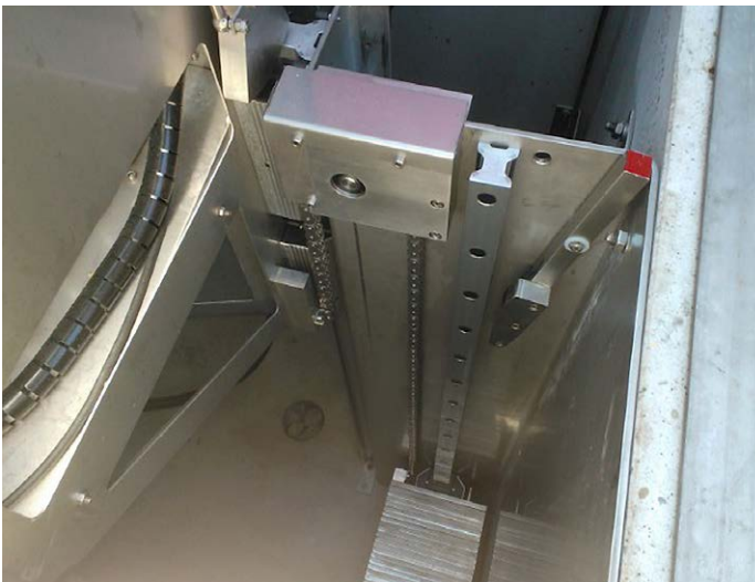
Hebemechanismus mit Gegengewichten (unten) und Arretierhebel (rechts).
